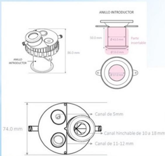
Sistema de sellado del canal neumático UNIVEC®.
