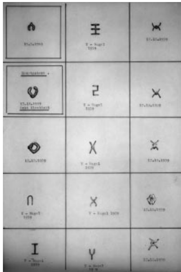
Figura 6. Diferentes secciones transversales estudiados por Küntscher.
