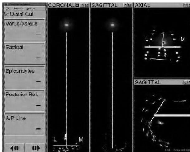
Figura 1. Pantalla del navegador con las tres referencias para analizar la rotación del implante femoral (ángulo LE-LCP*, línea LCP** y ángulo LAP-LE***).
