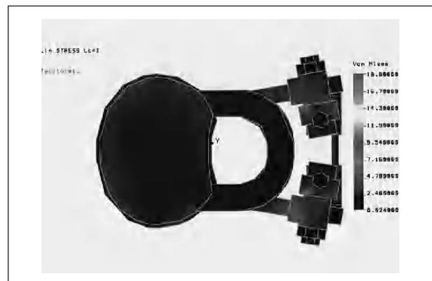
Figura 4. Diagrama de distribución de tensiones (corte coronal) con el fijador transpedicular.
