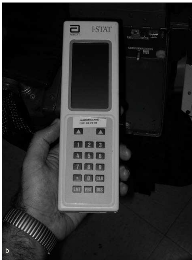
Fig. 1. a) Visión general del Life Support for Trauma and Transport (LSTAT). Su cubierta es de un material liviano y rugoso, y en su interior se encuentran las baterías y el oxígeno. En sus lados se hallan los puertos de entrada para su conexión a fuentes externas de energía y oxígeno; b) analizador químico portátil (i-STAT®). Las muestras de sangre arterial o venosa se colocan en su parte inferior y los resultados se pueden leer en la pantalla en 90 s. Al colocar el i-STAT® en su compartimento la información se transmite a la base de datos mediante un sensor infrarrojo.
