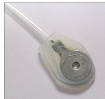
Figura 2. Extremo del sensor de presión intracraneal que se coloca tras trépano entre la calota y la duramadre.
