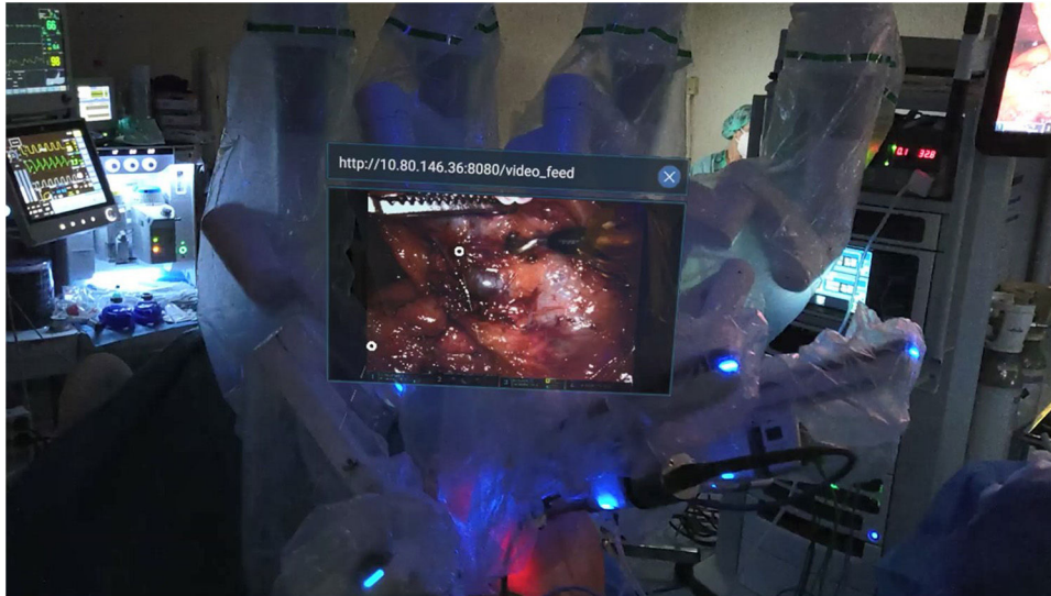
Figura 5 – Substitución de elementos físicos por virtuales. Pantalla virtual con la imagen de la cirugía sobre los brazos robóticos.
