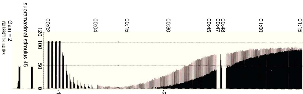
**Figura 3 – Registro electromiográfico de un bloqueo neuromuscular no despolarizante inducido por rocuronio. El punto 1 coincide con la administración de una dosis de intubación (0,6 mg/kg). Puede verse la recuperación espontánea del mismo hasta valores de TOFR 1 cercanos a la unidad. Fuente: autores.**
