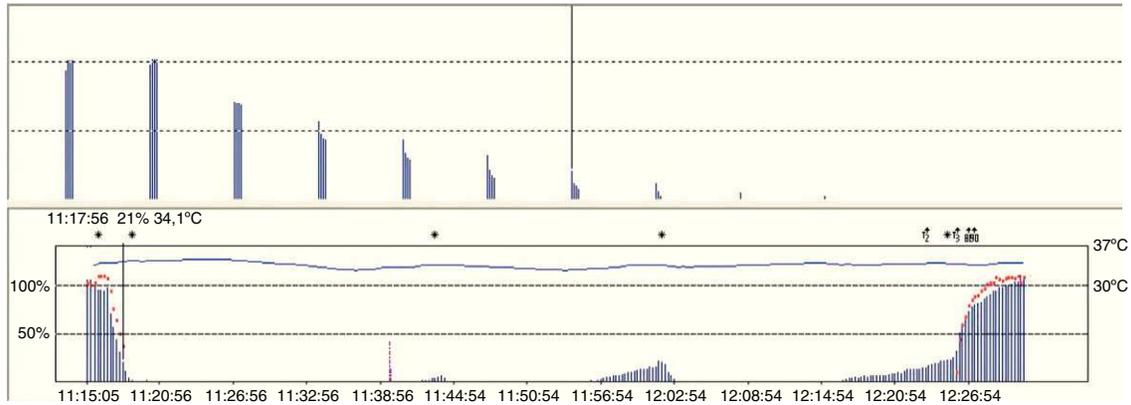
**Figura 6 – Registro de TOF (ACM). Aplicación de un tren de 4 estímulos con una frecuencia de 2 Hz cada 15 s. Se observa la pérdida de las respuestas sucesivas en relación al grado de curarización. Fuente: autores.**
