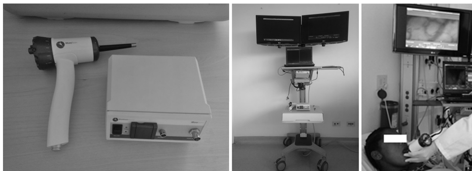
Figura 1 – Sistema de campo oscuro lateral ( sidestream dark-field [SDF] ): sistema para uso como microscopio de mano en el estudio de la microcirculación a la cabecera del paciente en tiempo real. Consta de guía de luz rodeada de diodos emisores de luz verde (530 nm) que penetra el tejido, iluminando la microcirculación. La luz verde es absorbida por la hemoglobina de glóbulos rojos, y una lente de aumento proyecta la imagen a una videocámara. (Reproducido con permiso del Dr. Gustavo Adolfo Ospina Tascón)
