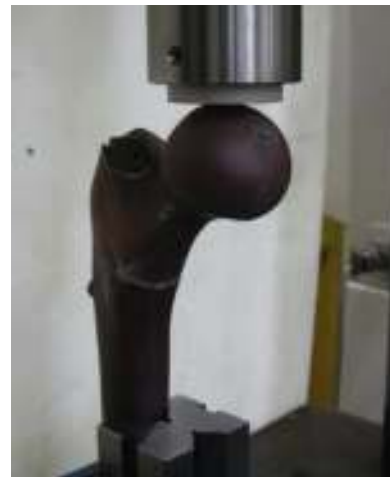
Figura 2 Montaje del sistema para la prueba de compresión estática.
