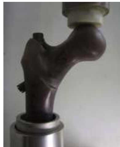
Figura 3 Montaje del sistema para las pruebas de fatiga por compresión.
