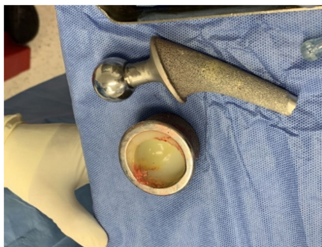
Figura 7 Fractura en la interface zona porosa-zona lisa del vástago.
