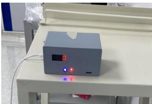
Figura 1 Inclinómetro. Calibrado a 0 grados
