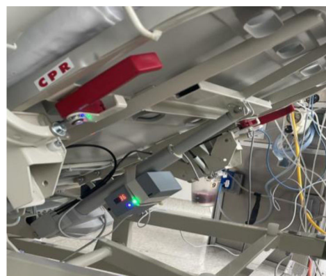
Figura 2 Inclinómetro activo ubicado en la cabecera de la cama de la UCI con registro a 36 grados de elevación.
