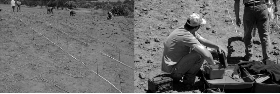
Figura 9. Tendido de electrodos “inteligentes” y adquisición de datos con el equipo eléctrico (fotografía: Julia Pérez Pérez, proyecto Agricultura en terrazas en el cerro San Lucas).
