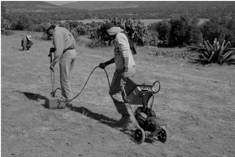
Figura 8. Levantamiento de perfiles con el radar de penetración terrestre (fotografía: Julia Pérez Pérez, proyecto Agricultura en terrazas en el cerro San Lucas, 2008).
