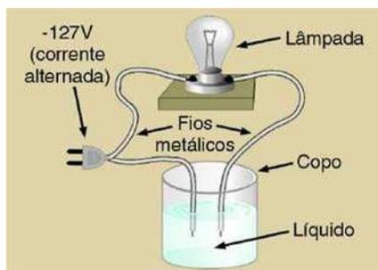
Figura 5. Teste de condutividade elétrica.
