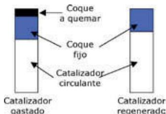
Figura 5. Componentes del catalizador gastado y del catalizador regenerado
