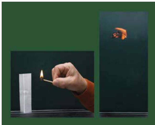
Figura 2. Elevación de la ceniza en la combustión de un cilindro de papel celulósico.
