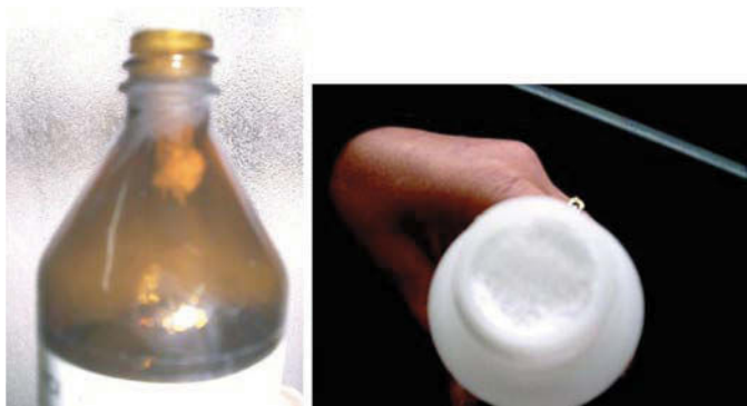
Figura 2. Se muestran dos frascos preparados para esta investigación de manera tal que los vapores de \text{NH}_3 estuvieran en contacto con los de \text{HCl} . Para ello se destapó una botella de \text{NH}_3 , se colocó a su lado una botella semitapada de \text{HCl} y ambas se cubrieron con una bolsa de plástico pegada con cinta adhesiva a la mesada durante 10 días aproximadamente. A la derecha se muestra una lámina de cristales de \text{NH}_4\text{Cl} generada bajo la tapa del envase que lo cubre totalmente.
