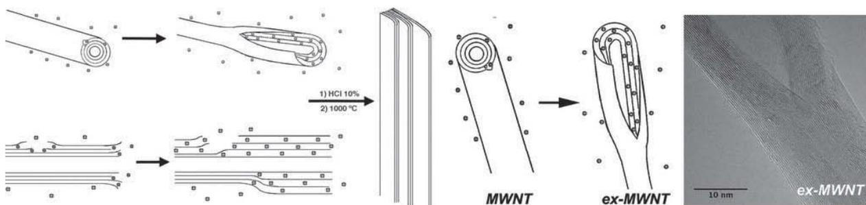
Figura 3. Método para obtención de grafeno por exfoliación.[10]
