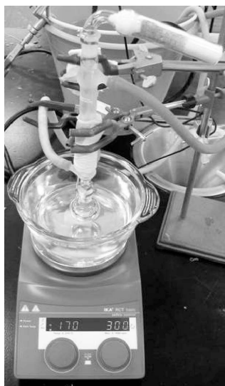
Figura 11. Reacción de polimerización por apertura de anillo (ROP) de la D,L-lactida iniciada por \text{Sn}(\text{Oct})_2 y alcohol bencílico como coiniador.
