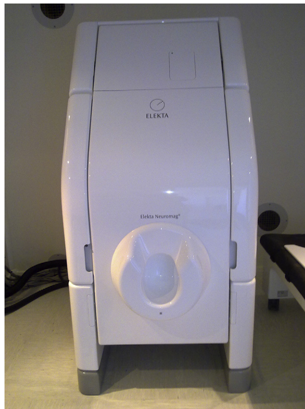
Figura 1. Sistema de registro MEG Neuromag-Vector View. Foto obtenida en el Laboratorio de Neurociencia Cognitiva y Computacional (UCM-UPM), Centro de Tecnología Biomédica, Universidad Politécnica de Madrid.
