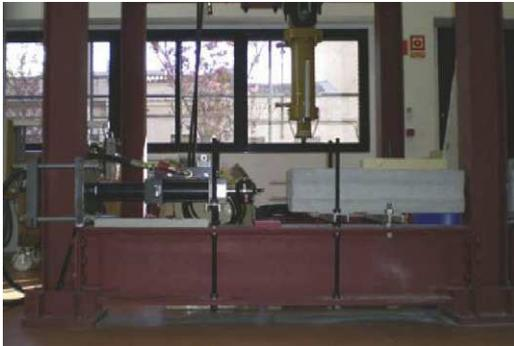
Figura 8. Alineación entre el bloque y el actuador.
