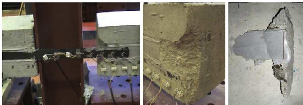
**Figura 14.** Daño en el bloque de hormigón y en el adhesivo con la carga máxima de 25 kN.
