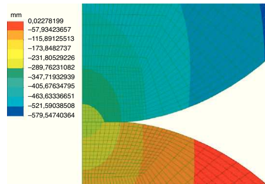
Figura 11. Contacto entre dos cilindros elásticos. Campo de desplazamientos.
