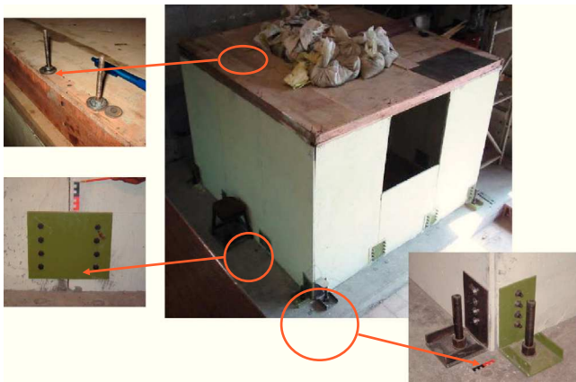
b Prototipo antes del ensayo y detalle de uniones
