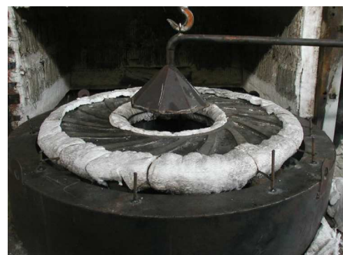
Figura 1. Rodete preparado para ser templado
