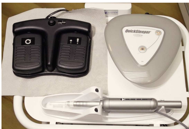
Figura 1. Componentes del sistema de anestesia Quick-Sleeper: unidad de control (arriba a la derecha), pieza de mano (abajo) con accionamiento motorizado para la perforación rotatoria del hueso compacto y la inyección controlada por ordenador, así como pedalería (arriba a la izquierda) con pedal derecho para el control de la perforación y pedal izquierdo para controlar la inyección.
