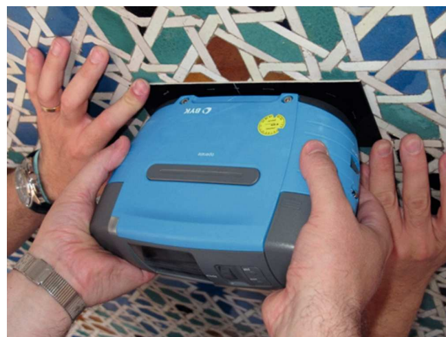
Figura 2 – Máscara negra de 23 mm de diámetro (arriba) y medida con el goniocolorímetro BYK-mac de la zona seleccionada por la máscara (abajo).
