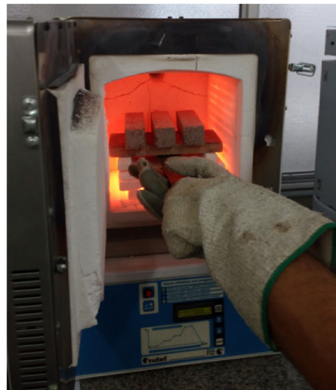
Figura 2 – Extracción de probetas durante el ensayo de choque térmico.
