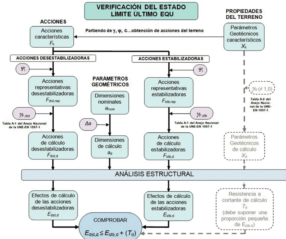
Figura 10. Diagrama de flujo para la verificación del estado límite último de equilibrio estático EQU.
