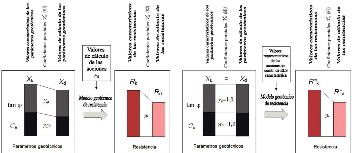
Figuras 6 y 7. Esquema de obtención de los valores de cálculo de las resistencias según el Enfoque de Proyecto 2 con  $\gamma_M = 1,0$  (M1) y  $\gamma_F \neq 1,0$  (A1) (esquema de la izquierda) y según el Enfoque de Proyecto 2\* con  $\gamma_M = 1,0$  (M1) y  $\gamma_F = 1,0$  (A1) (esquema de la derecha).
