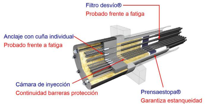
Figura 2. Anclaje Freyssinet.
