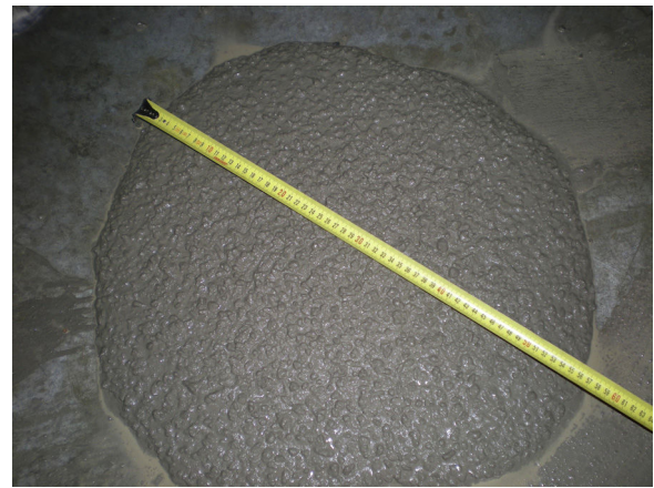
Figura 2. Ensayo de escurrimiento.
