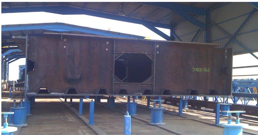
Figura 6. Cajón central en fabricación.
