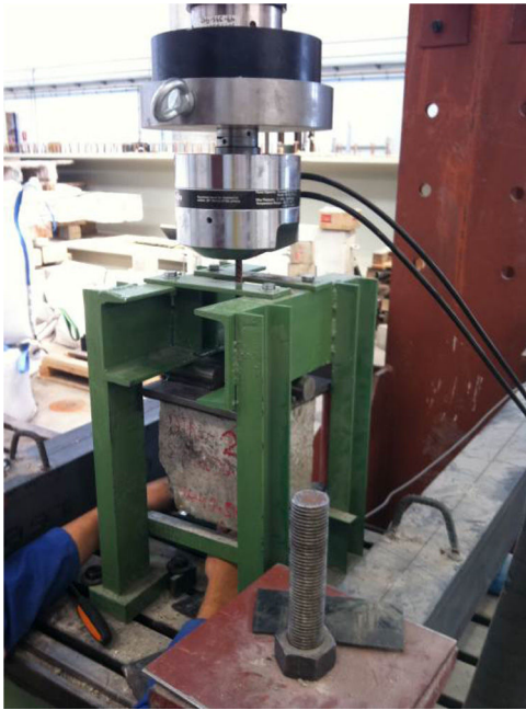
Figura 11. Ensayo de adherencia pull-out en laboratorio.
