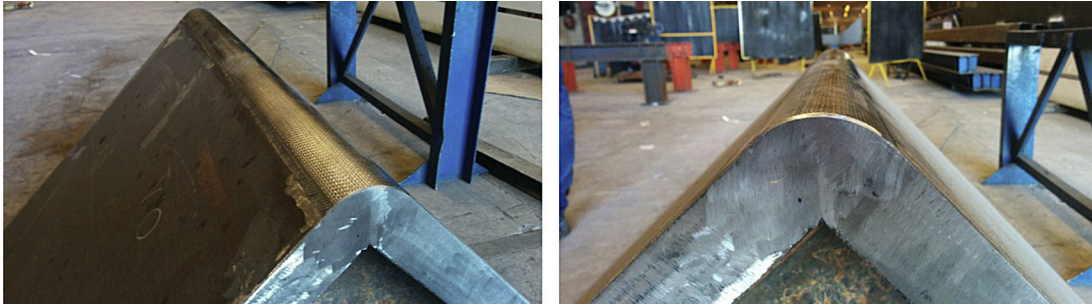
Figuras 33 y 34. Ensayo de soldadura y mecanizado posterior de la unión en arista del mástil.
