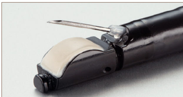
FIGURA 7. DETALLE DEL EXTREMO DISTAL DEL ULTRASONÓGRAFO ENDOBRONQUIAL CONVEXO
