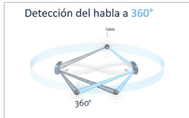
FIGURA 3. COMUNICACIÓN INHALÁMBRICA E INTERCAMBIO DE DATOS ENTRE LOS AUDÍFONOS DERECHO E IZQUIERDO, QUE PERMITE LA DETECCIÓN Y UBICACIÓN DE LA FUENTE DE SONIDO EN 360°
