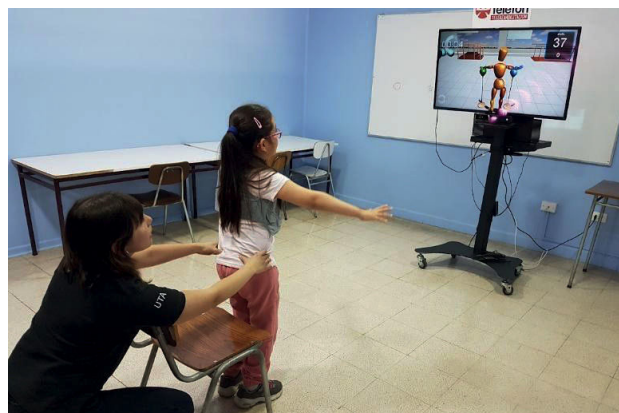
Figura 8. Plataforma de rehabilitación virtual en base a sensor de captura de movimientos Microsoft Kinect®
