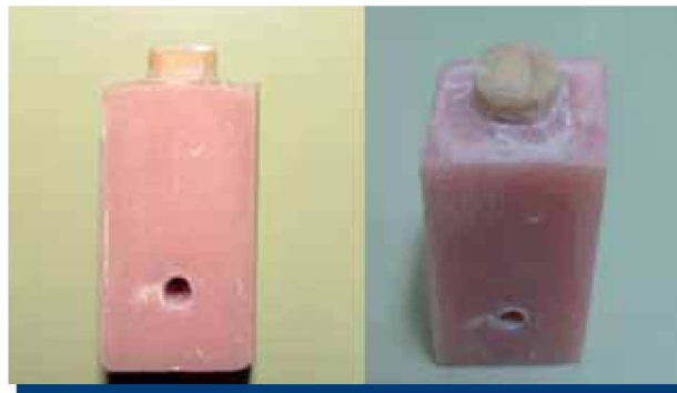
Figura 1. Muestra de cerámica incluida en cilindro de resina acrílica de autopolimerización.
