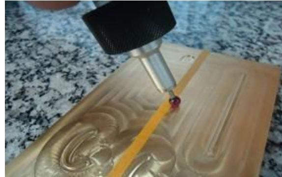
Fig. 1. Medição de empenamento.
