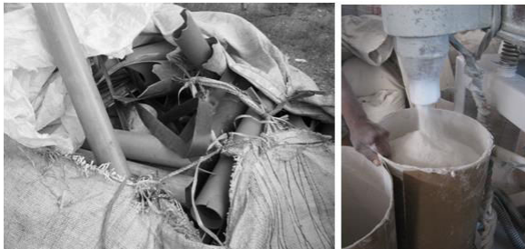
Fig. 5. Reciclagem mecânica. a) Fardos com resíduos de PVC separados; b) resíduo de PVC micronizado.
