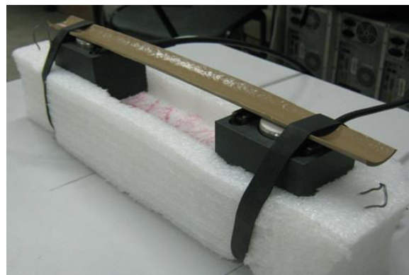
Fig. 7. Disposição dos sensores para captação do sinal, Emissão Acústica.
