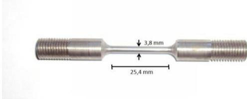
Fig. 1. Corpo de prova utilizado nos ensaios de tração conforme Norma NACE TM177-90.
