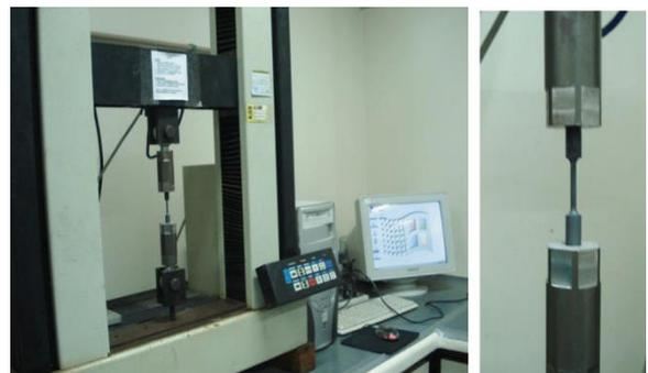
Fig. 3. (a) Máquina de ensaios de tração com computador para aquisição de dados e (b) corpo de prova em tração (LAPEC-UFRGS).
