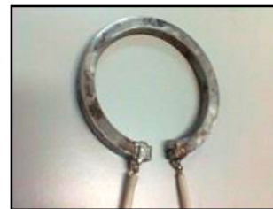
Fig. 6. Anel segmentado com terminais para medida da resistividade elétrica.
