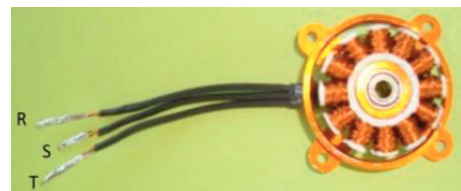
Fig. 12. Estator do mini motor instalado na carcaça.
