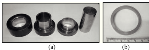
Fig. 1. Amostras na forma de anel – (a) matriz – (b) corpo de prova.
