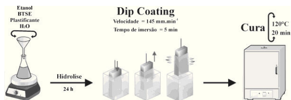
Fig. 1. Esquema ilustrativo dos parâmetros experimentais utilizados na síntese dos filmes e das etapas do processo de dip coating .
