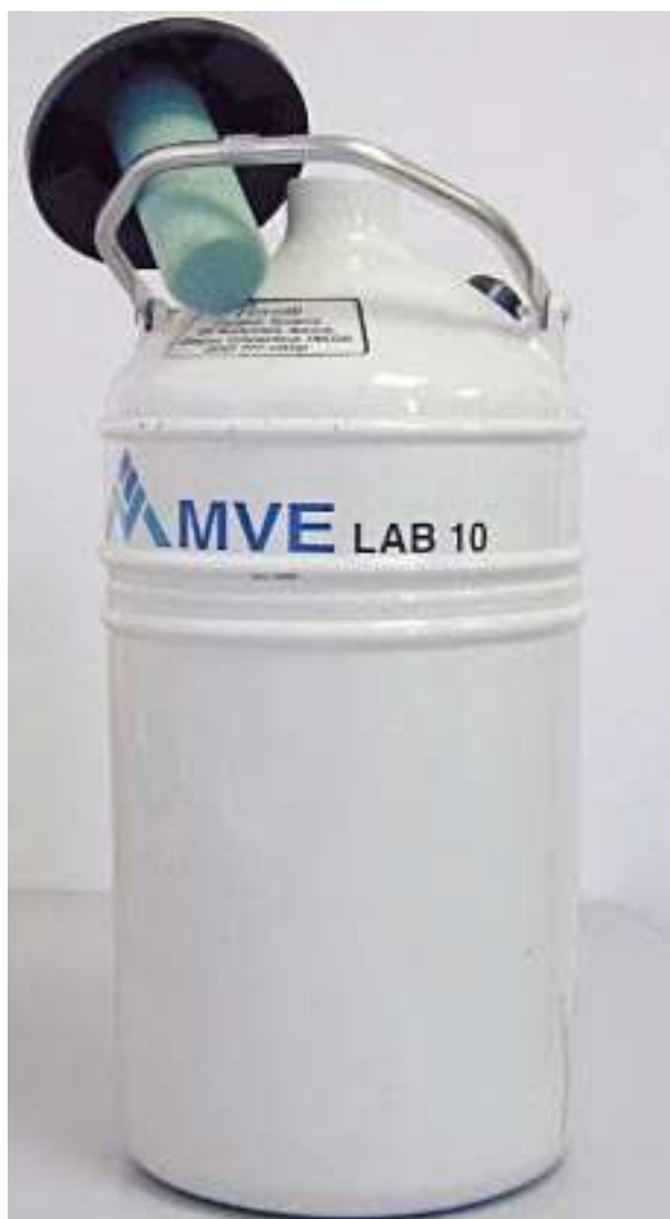
Figura 2. Tanque de almacén (10 litros) de nitrógeno líquido.
