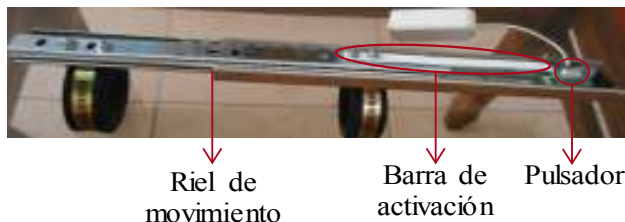
Figura 11. Mecanismo de activación por pulsador propuesto
