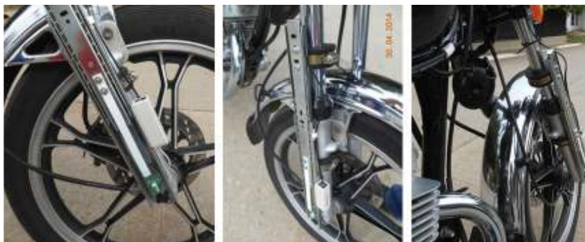
Figura 12. Adaptación del mecanismo de activación por perturbación construido
