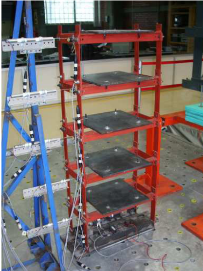
Figura 2. Estructura a escala de cinco GdL.
