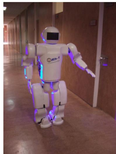
Figura 9. Rh1, robot humanoide de tamaño natural (UC3M).
