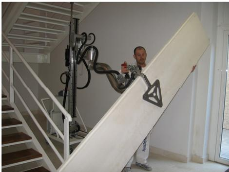
Figura 7. Robotab2000, robot de asistencia para el manejo de cargas elevadas (CSIC).
