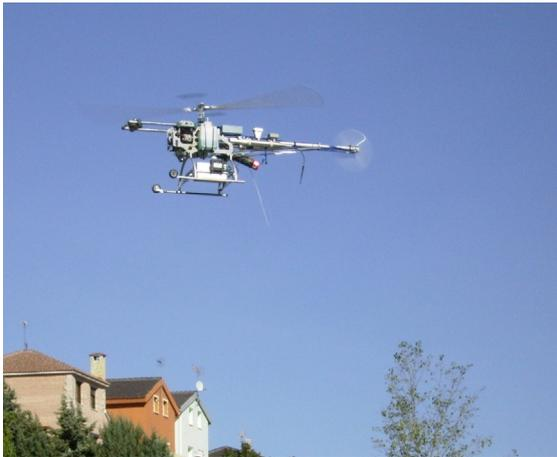
Figura 3. Robot helicóptero para inspección y vigilancia (UPM).
