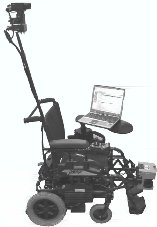
Figura 1. La silla eléctrica de navegación autónoma SENA.
