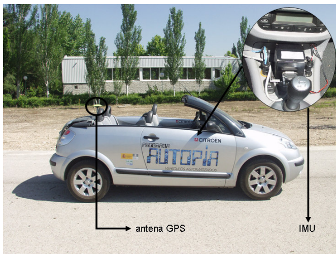
Figura 2. Citroën C3 Pluriel. Detalle de la ubicación del sistema de medida inercial y de la antena de recepción de la señal GPS.
