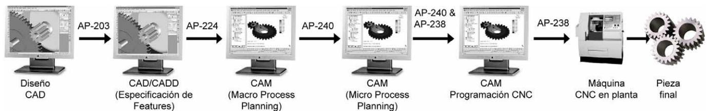
Figura 2. Escenario STEP de diseño y fabricación de piezas mecanizadas.
