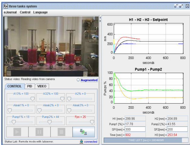
Figura 6. GUI del sistema de tres tanques – modo remoto con realimentación por vídeo.
